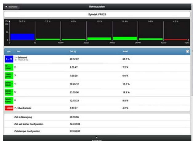
Betriebsdauer in verschiedenen Drehzahlbereichen Visualisierung des konfigurierbaren Betriebsstundenzählers im MiniCODER mit Sonderausstattung P
